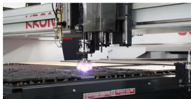
Kronos di Ficep è dedicata alla lavorazione della lamiera pesante. E' capace di trattare pezzi larghi 3,2 mt e lunghi oltre 40
