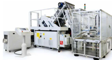
Sacmi: pressa per tappi a corona per la parte metallica e non la guarnizione (6.000/minuto). Nella macchina entra un foglio di lamiera (comunemente tin free steel, verniciato e laccato) che la pressa trancia e sagoma per dare origine alla tipica forma del tappo a corona. Un'altra macchina completa il tappo, stampando la guarnizione
