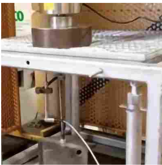
Prove di resistenza alla pressione con sollecitazioni cicliche. Immagine presa da Icimgroup.com
