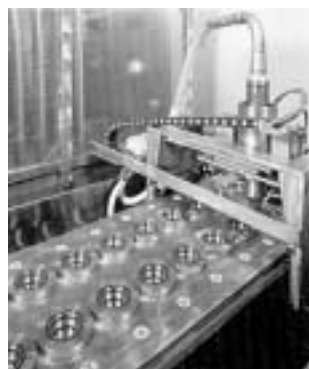
Fig. 237 Dosaggio prodotti in polvere (particolare del distributore)
