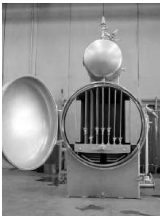
Fig. 61 Autoclave orizzontale per rocche
