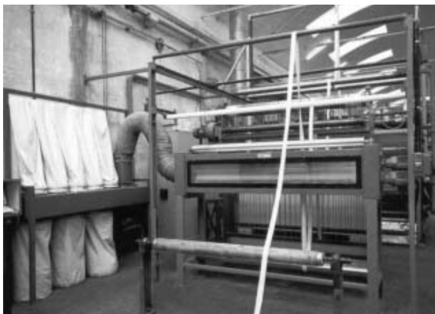
Fig. 225 Spazzolatrice con sistema aspirazione
