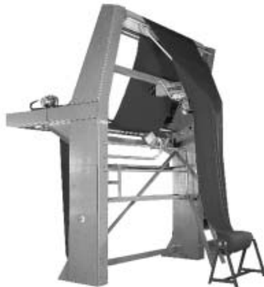
Fig. 223 Taglio, apertura e centratura di maglia tubolare
