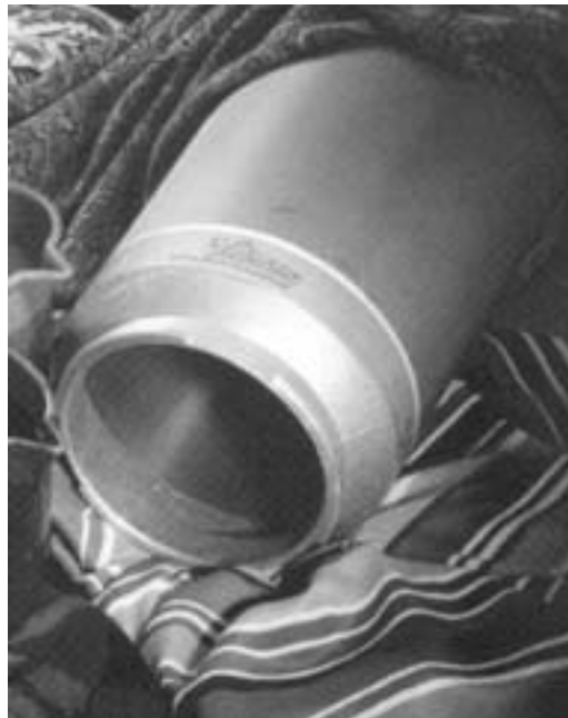
Fig. 102 Quadro per stampa piana Fig. 103 Cilindro con ghiera per stampa rotativa
