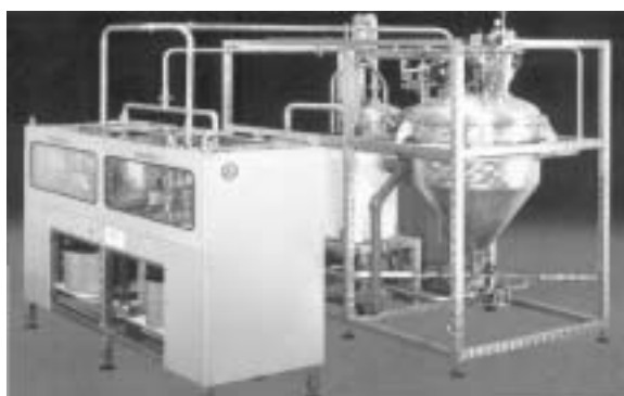
Fig. 241 Particolare di un sistema di dosaggio con la tecnica del vuoto
