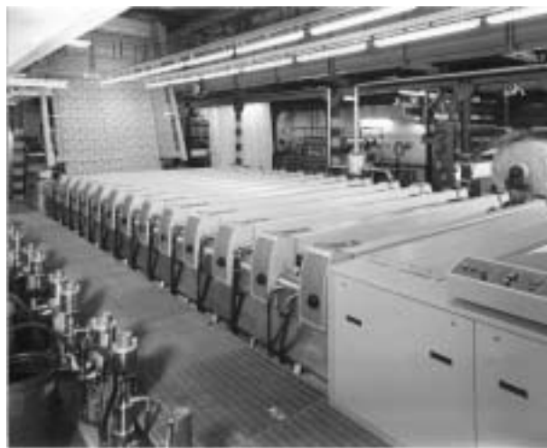
Fig. 115 Immagini di macchine per stampa a cilindri cavi
