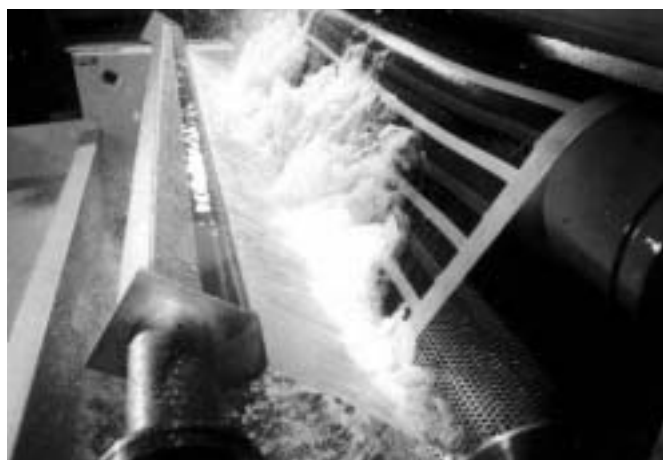
Fig. 21 Sistema di lavaggio a lame d'acqua
