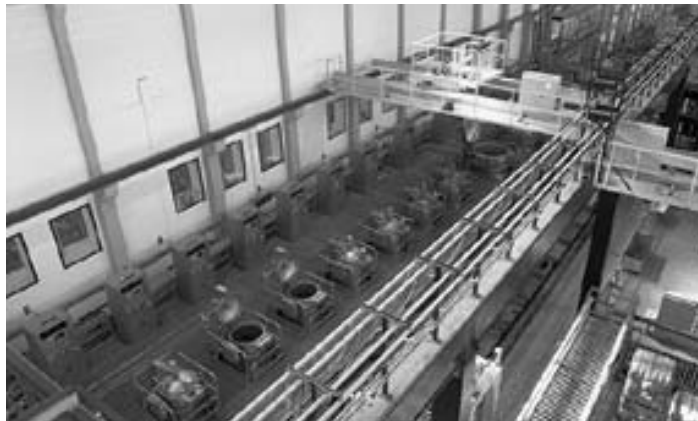
Fig. 242 Impianto completamente robotizzato per la tintura di rocche, dotato di gru per il trasporto dei portamateriali e il carico/scarico delle macchine.
