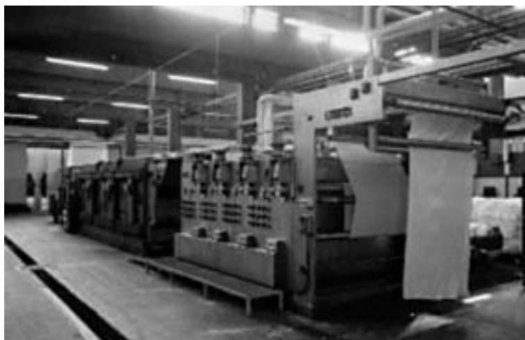
Fig. 14 Impianto per la decorticazione in continuo del PES
