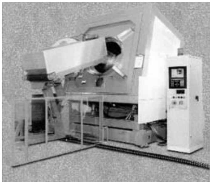
Fig. 88 Macchina per tintura in capo con PLC e carico a navetta robotizzata
