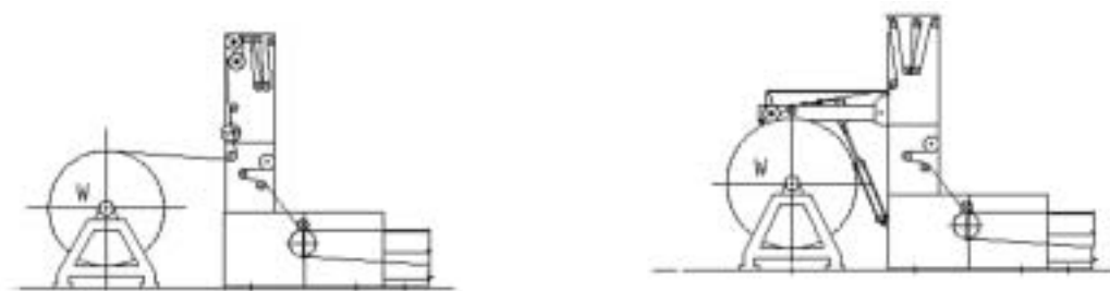
Fig. 108 Manomacchine: schemi di dispositivi d'entrata
