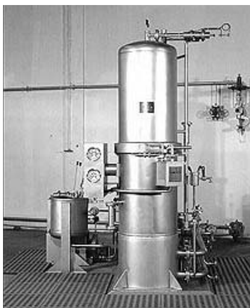
Fig. 59 Autoclave verticale a carico variabile e relativo portamateriali
