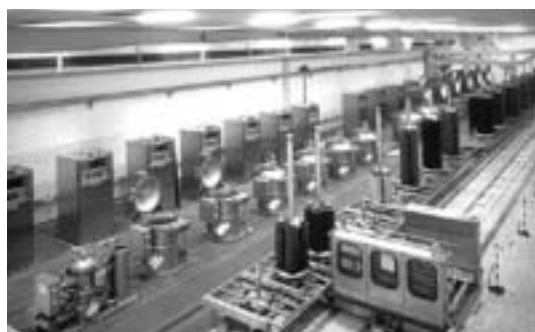
Fig. 243 Modulo a sei colonne robotizzato: immagine e schema carico/scarico rocche
