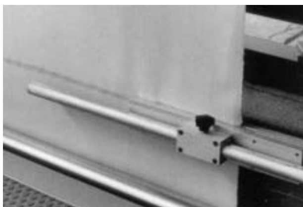
Fig. 230 Rilevatore di cuciture (segnalazione o taglio)
