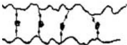
Fig. 183 Catene di poliglucosio reticolate con "Cellulose-Reactants"
