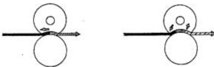
Fig. 95 Eliminazione dell'acqua da tessuti mediante l'utilizzo di cilindri a superficie liscia e porosa: le frecce indicano il flusso dell'acqua
