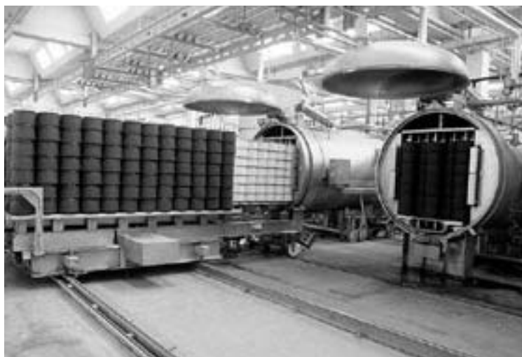
Fig. 57 Autoclave orizzontale con portamateriali
