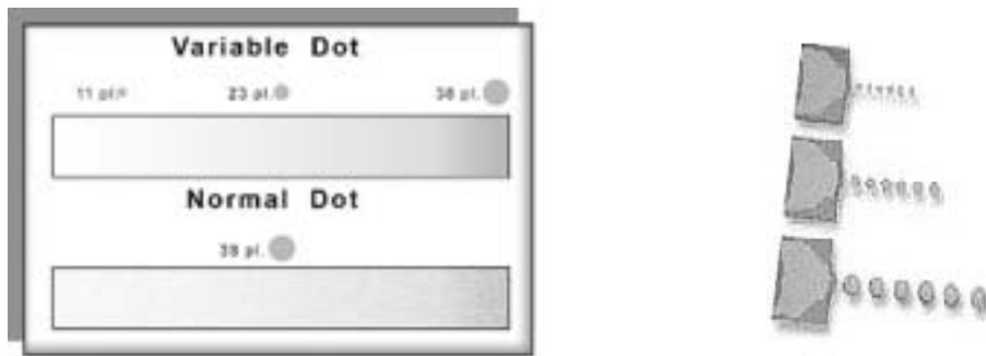
Fig. 135 Modulazione della goccia
