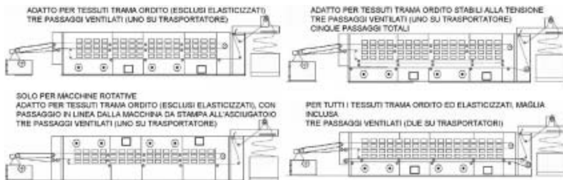
Fig. 112 Mansarde d'asciugamento per manomacchine e rotative
