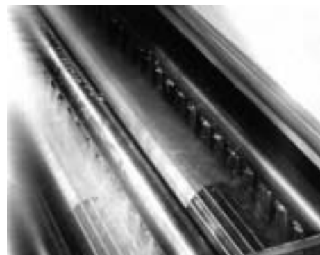
Fig. 128 Particolare degli ugelli spruzzatori
