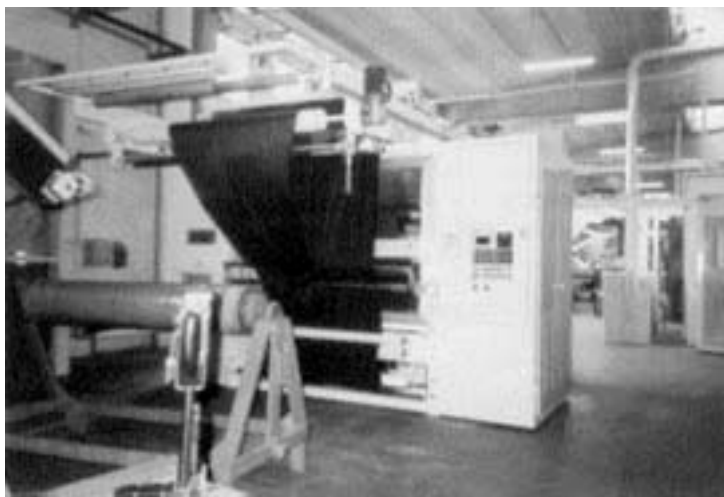
Fig. 160 Garzatrice con 2 tamburi rotanti di 24 cilindri ciascuno
