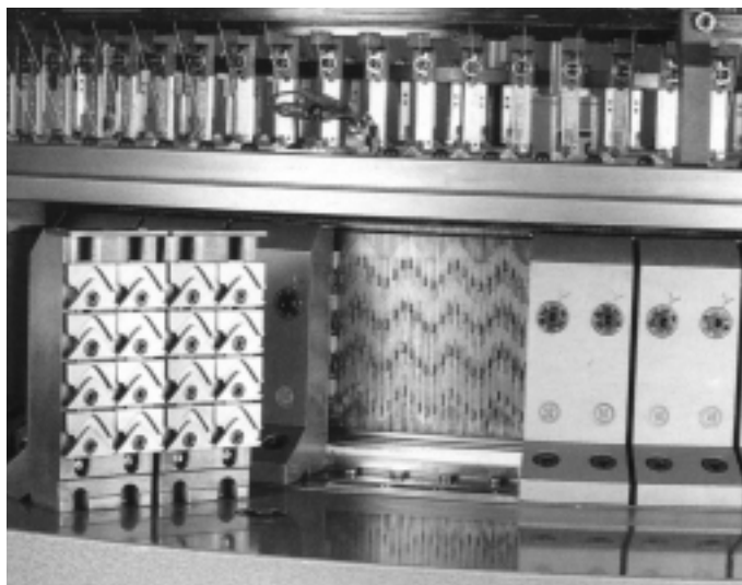
Fig. 85 Macchina monofrontura con 2 settori smontati, sono visibili le 4 piste di cammes.
