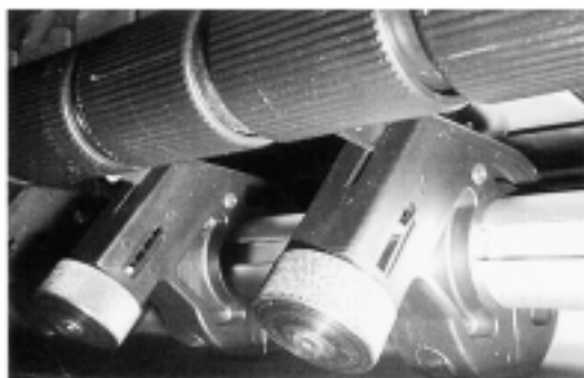
Fig. 63 Sistema di tiraggio con rullo principale a settori e controrulli regolabili singolarmente
