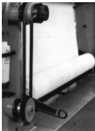
Fig. 99 Collegamento a frizione tra il rullo avvolgitore e i rulli del sistema di tiraggio
