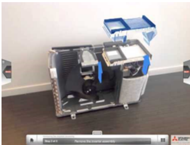
Fig. 31: Suggerimento di intervento da parte dell'applicazione sviluppata da Mitsubishi per il supporto agli interventi di manutenzione degli impianti di climatizzazione
