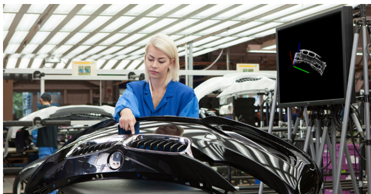
Fig. 23: Controllo Qualità assistito da Sistemi di Gesture Recognition in BMW
