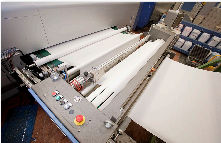
In alto: particolari dell'impianto allestito nello stabilimento di Govone della Miroglio, in grado di stampare 350 metri di stoffa all'ora, che presto sarà affiancato da una macchina "gemella".
